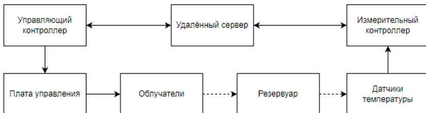
Рис.1 Структурная схема устройства для ультразвуковой заморозки мяса
