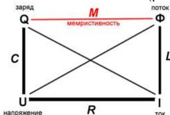
Рис. 1 – Соотношения физических величин в физических элементах электросхемы
