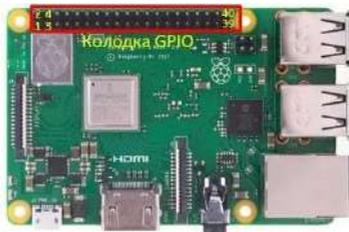
Рис. 1 – Выводы GPIO.
