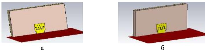
Рис. 1 – Модели планарных конденсаторов гребенчатого типа с тремя гребнями в нижней части (а) и верхней части (б)
